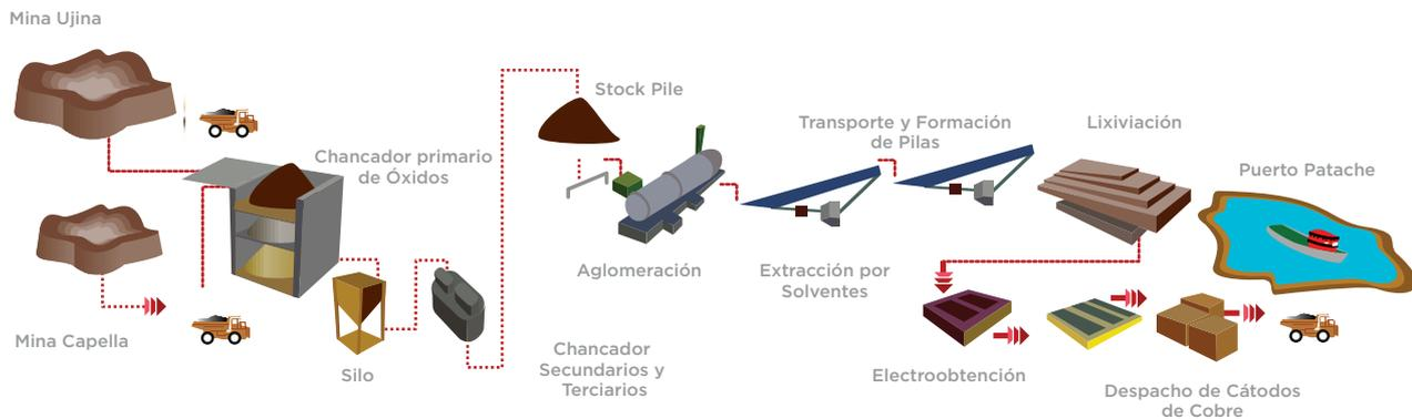
**Figura 2: Diagrama del proceso productivo de los cátodos de cobre de Collahuasi.**
